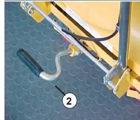
Após parafusar a alça, fixar o pedal (2) com as arruelas, porcas e parafusos enviados junto da máquina.
