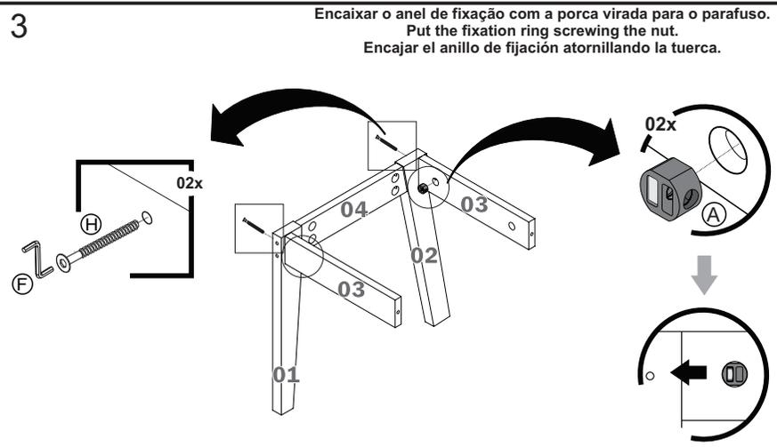
**Encaixar o anel de fixação com a porca virada para o parafuso.**
