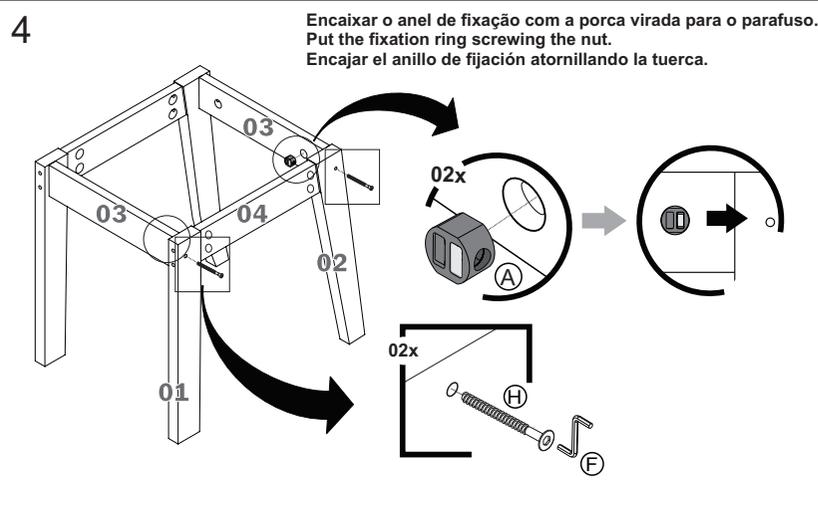
**Encaixar o anel de fixação com a porca virada para o parafuso.**
