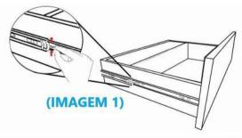
Retirada da Gaveta: Primeiro abrir totalmente a gaveta. Ao mesmo tempo, do lado esquerdo, pressione o dispositivo para cima e do lado direito, pressione o dispositivo para baixo. Em seguida, puxe a gaveta.
