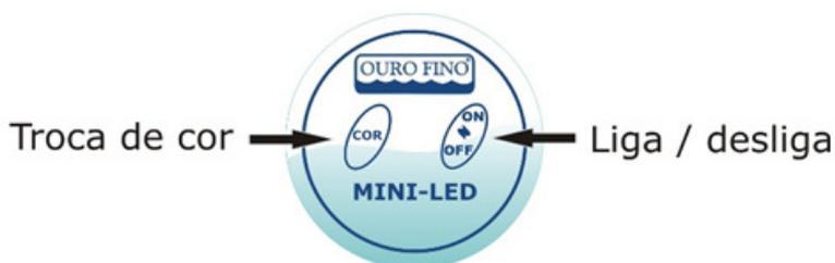
O botão de acionamento eletrônico controla o acionamento das luminárias, através dele ligamos e desligamos as luminárias e fazemos à troca dos programas de cores. Ele já sai da fábrica instalado na borda da SPA.
