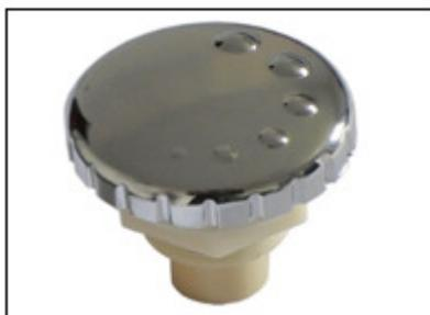
**VÁLVULA DE CONTROLE DE AR:** Controla a quantidade de ar na mistura ar mais água nos jatos de hidromassagem. Girando no sentido horário reduz-se quantidade de ar misturada na água, diminuindo a quantidade de bolhas. Girando no sentido anti-horário aumenta a quantidade de ar misturada na água, aumentando a quantidade de bolhas.
