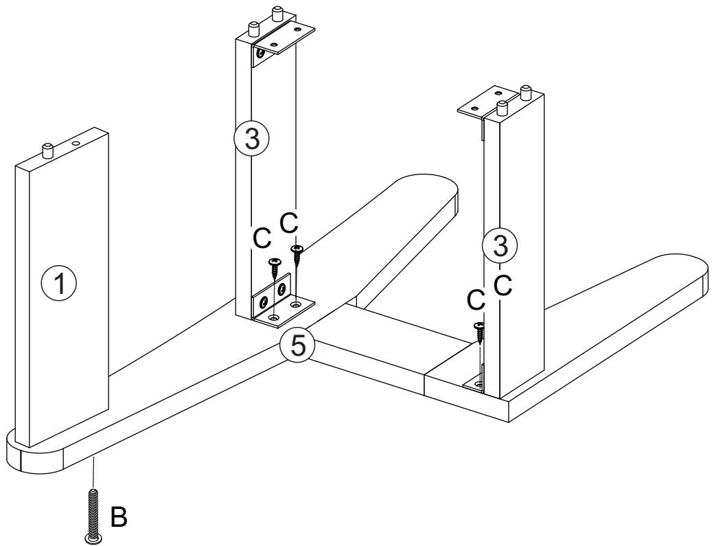
**3** Encaixe as peças (1 e 3) na peça (4) e fixe com os parafusos (B e C), conforme desenho.
