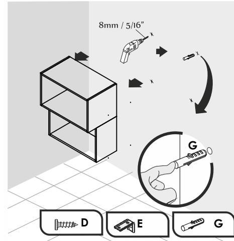
**09** Fixação do Armário na Parede
