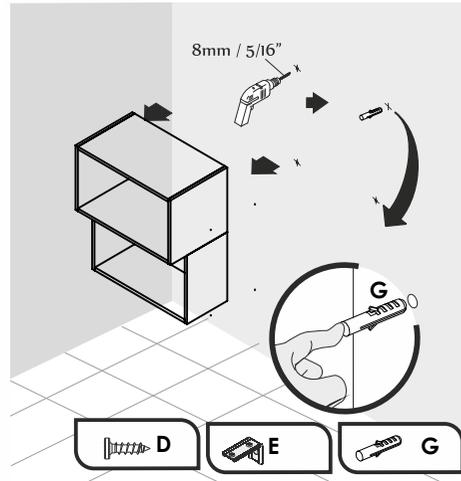
**09** Fixação do Armário na Parede
