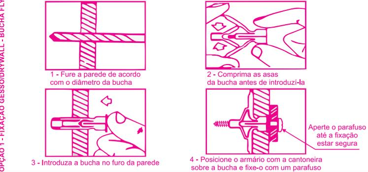
**ATENÇÃO:** Caro(a) cliente, na ferragem desse produto contém componentes para instalação do móvel em parede de alvenaria. Para fixação do armário em paredes de gesso acartonado/drywall, é necessário adquirir, em uma loja de material de construção, a ferragem específica para esses tipos de parede
