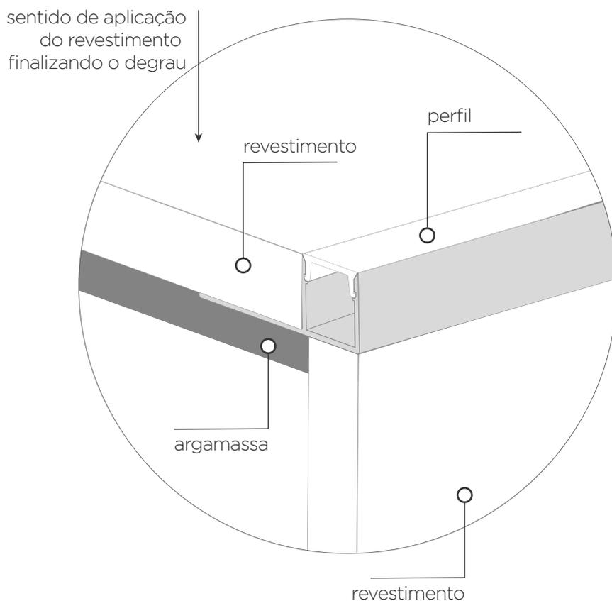
Continue aplicando o restante dos revestimentos se houverem mais quinas com a mesma técnica de aplicação, cuidando com o nivelamento.
