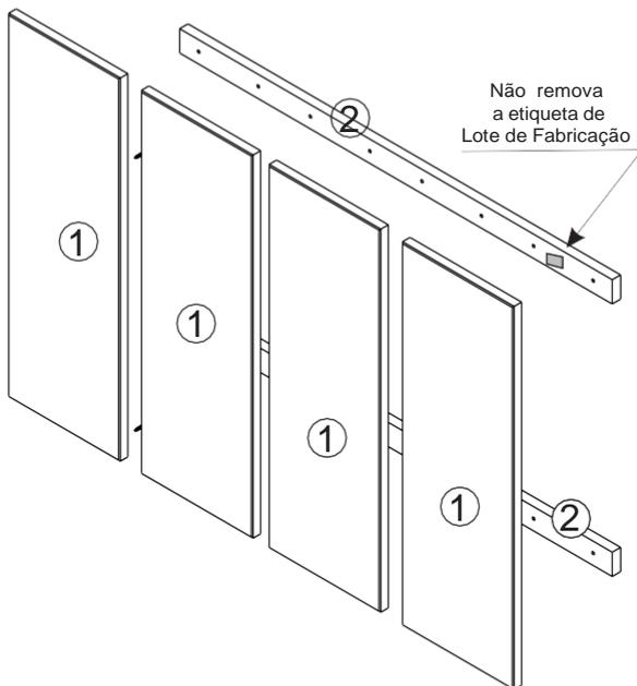
**1** Fixar travessas (2) usando parafuso (C) conforme detalhe.
