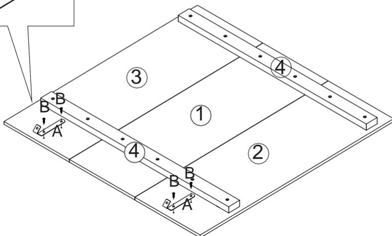
**3** Definir lado e fixar telhado usando parafuso (B) conforme detalhe.
