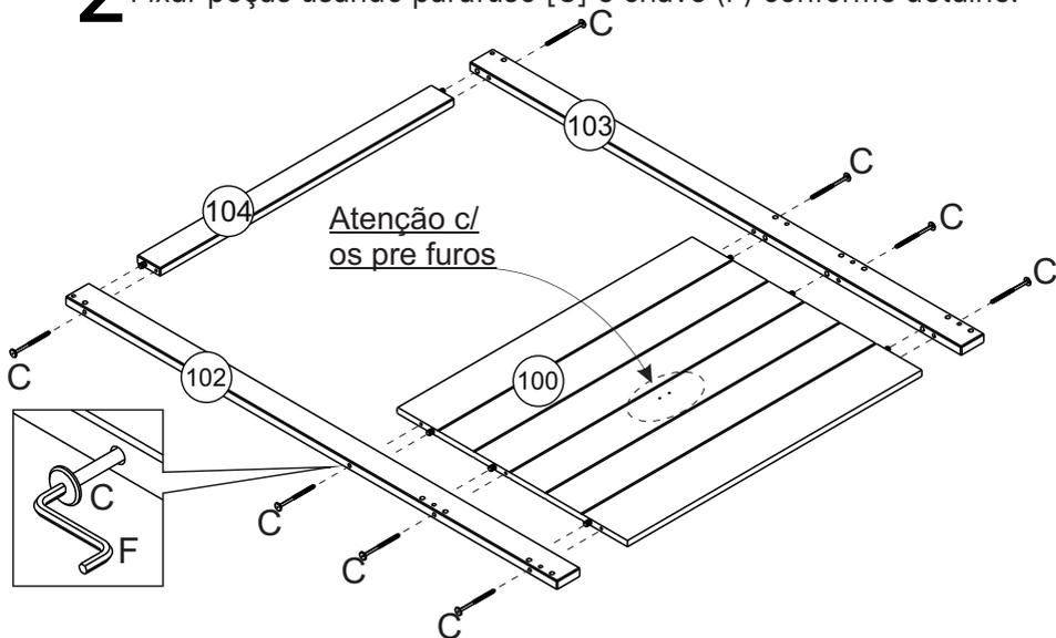
**3** Fixar peças usando parafuso [C] e chave (F) conforme detalhe.
