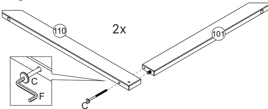
**10** Fixar conjunto montado com o parafuso (D) conforme detalhe.
