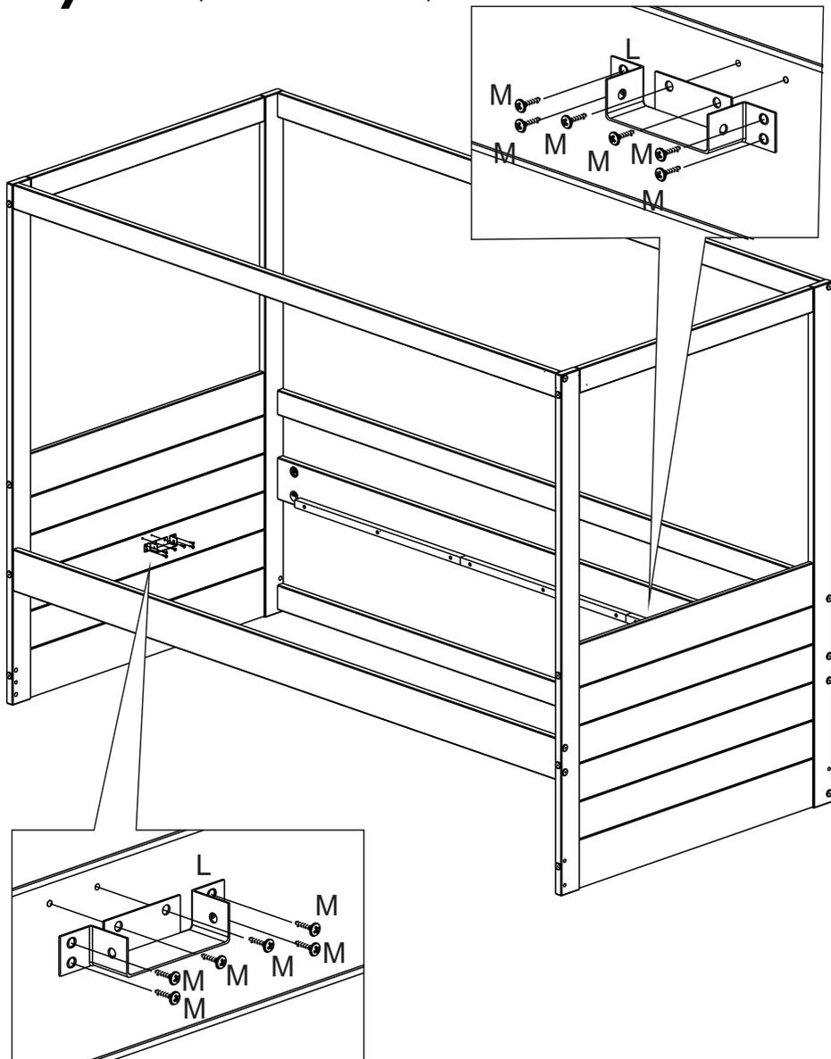
**8** Fixar peça (111) usando parafusos (M) conforme detalhe.
