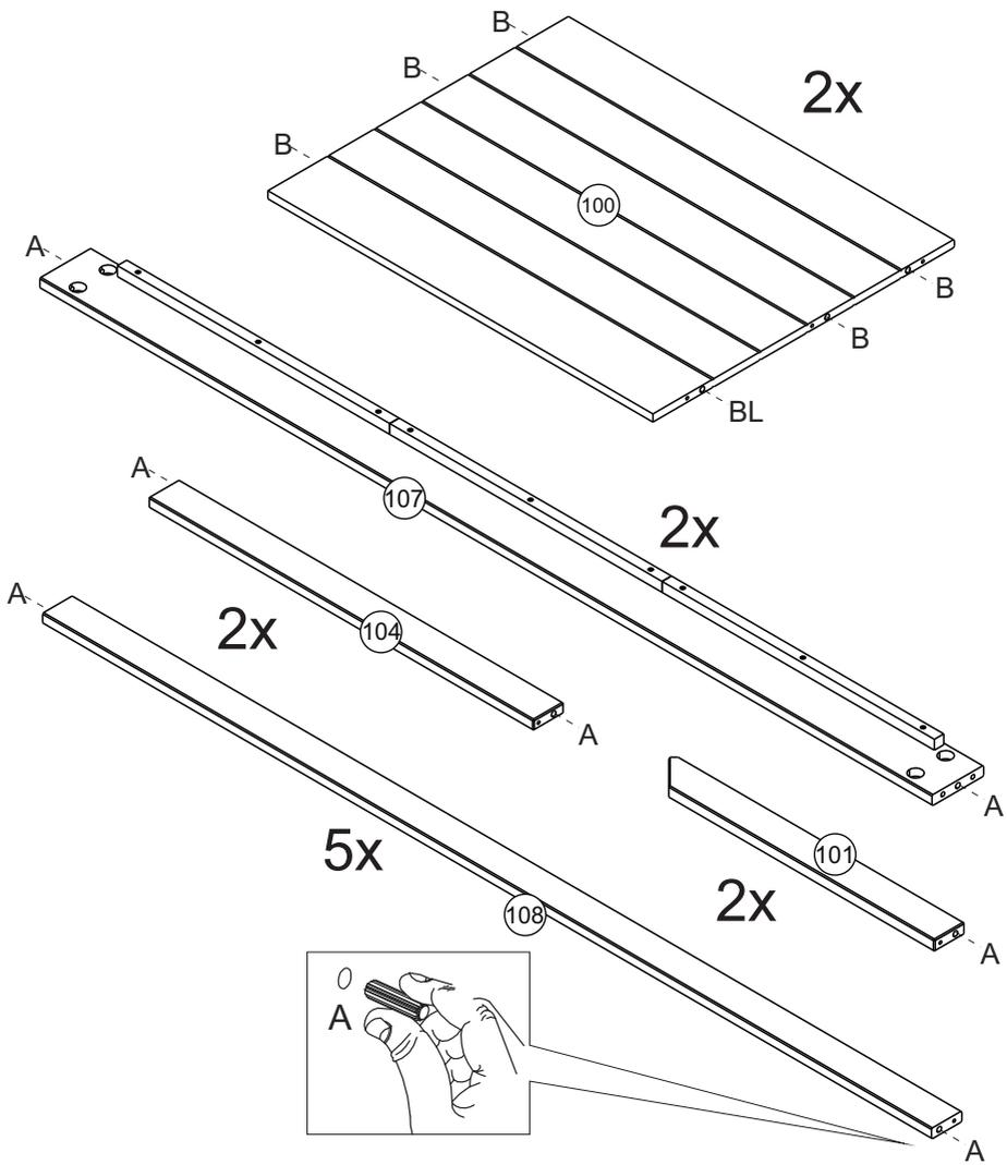
**2** Fixar peças usando parafuso [C] e chave (F) conforme detalhe.
