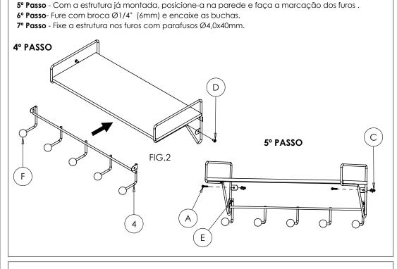
4º Passo- Coloque os parafusos M48mm e as porcas. (Ver Fig.3)
