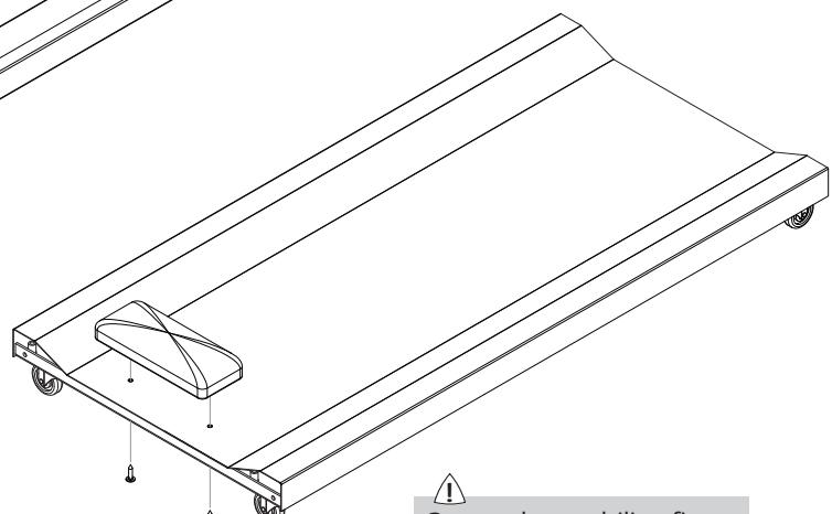
⚠ Com a chave philips fixe o encosto com os parafusos auto atarrachantes
