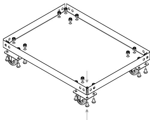
1 - Posicione os rodízios sob a bandeja inferior deixando alinhado com a furação, com os parafusos lentilha + porcas autotratantes, fixe os rodízios como na figura ao lado. Após, com o auxílio da chave de fenda e umas chave combinada de o aperto final em todos os parafusos.
