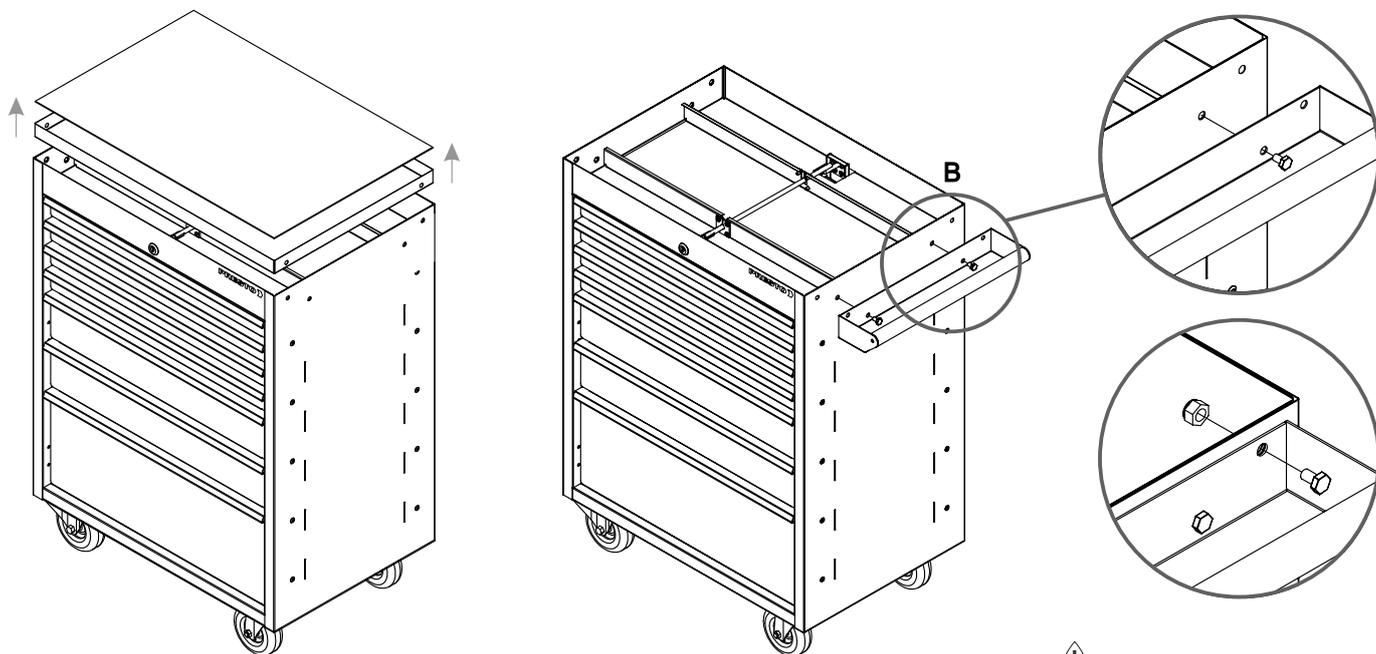
⚠ Para fixação do cabo retire a bandeja superior para ter acesso a furação interna e fixar as porcas nos parafusos.
