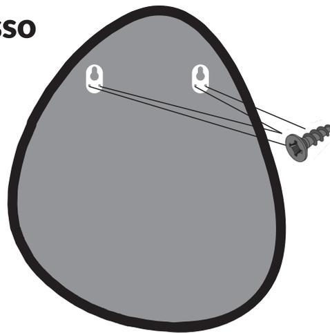
PARAFUSAR OS SUPORTES PARA MOLDURA ATRÁS DO PAINEL COM OS PARAFUSOS 3,5X14.
