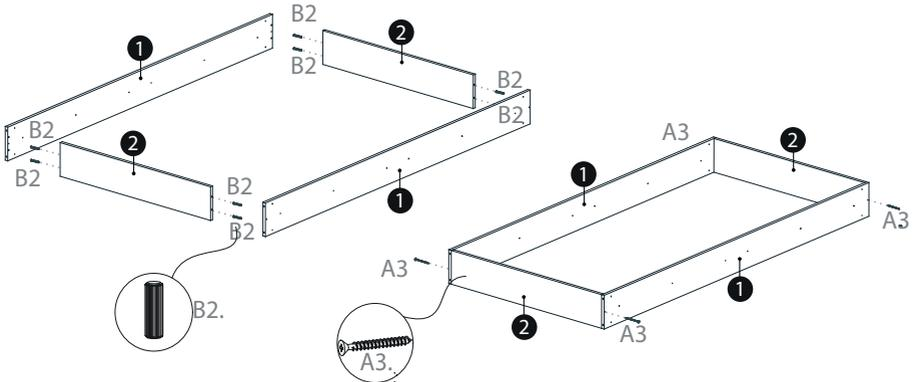
Obs: Faça a montagem do quadro superior utilizando as peças 2 e 13, da mesma maneira como a montagem do quadro inferior.
