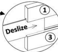
Deslize a peça 2 entre a os vão de encaixe das peças 1 e 3
