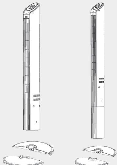
Passe o cabo de alimentação através do canal do pilar, e aperte firmemente o pilar com pilar.
