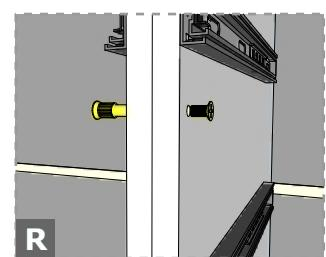
Após a furação, utilize o parafuso de união de 30mm (R) para fixar os produtos.
