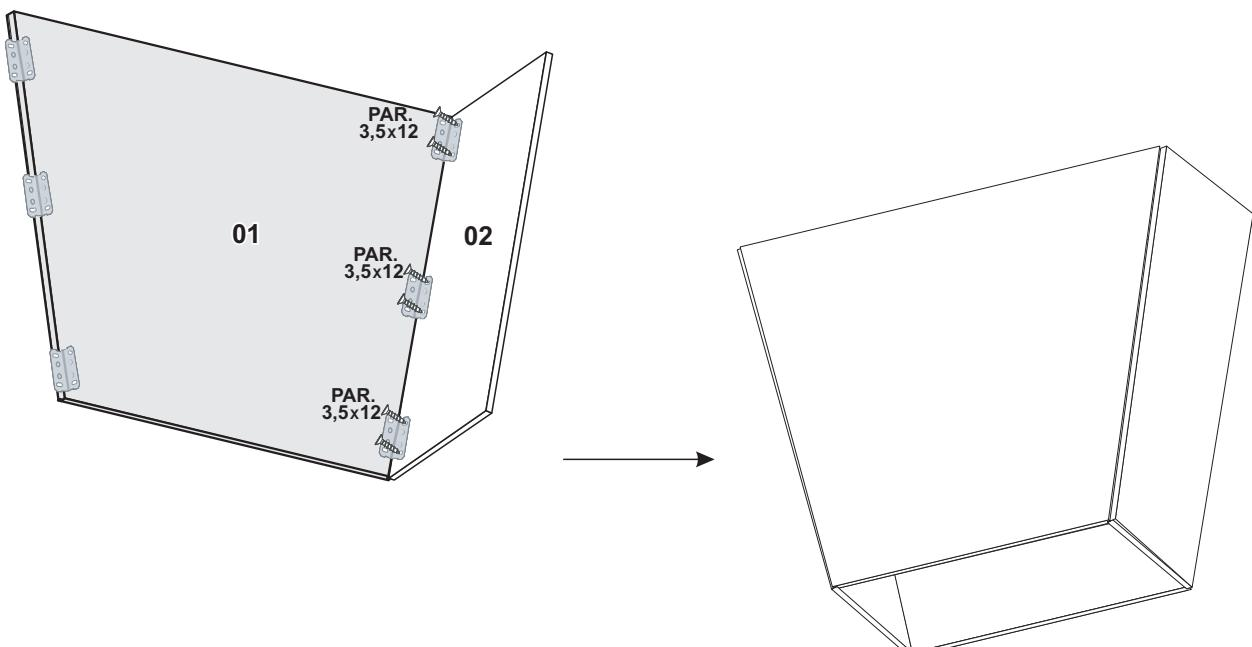
**2º PASSO** - SEPARA AS SAPATAS 1 ABA E FIXE- AS COM A ABA PARA DENTRO DE SUA BASE.
