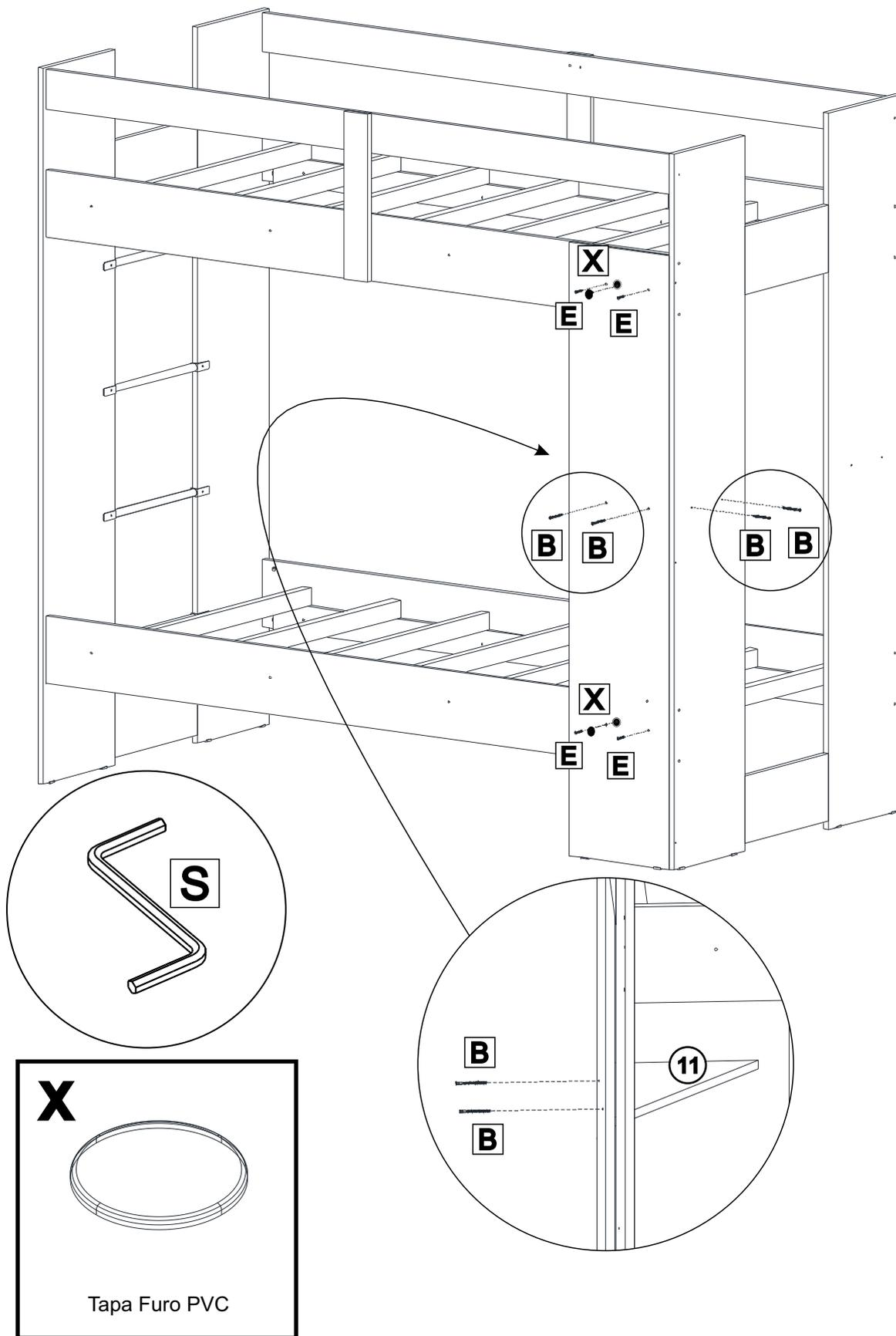
Finalizar a montagem introduzindo a tampa «P» nos parafusos «B».
