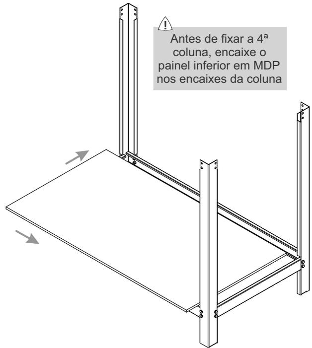
⚠ Antes de fixar a 4ª coluna, encaixe o painel inferior em MDP nos encaixes da coluna
