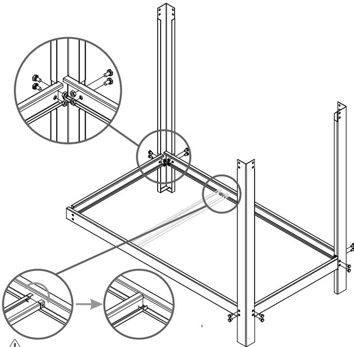
⚠ As bancada de 1,50m e 2m acompanham um reforço para encaixe nas travessas inferiores maiores. Para fixar basta encaixar o rasgo do reforço na dobra da travessa e girar até que fique na horizontal. (conforme figura acima).
