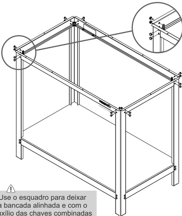
⚠ Use o esquadro para deixar a bancada alinhada e com o auxílio das chaves combinadas aperte todos os parafusos
