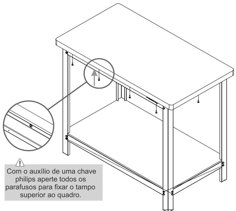
⚠ Com o auxílio de uma chave philips aperte todos os parafusos para fixar o tampo superior ao quadro.
