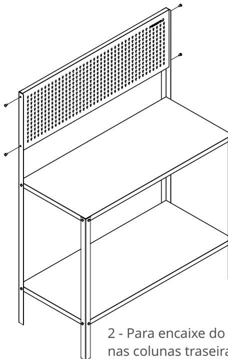
2 - Para encaixe do painel, posicione nas colunas traseiras até "encontrar" as furações, fixe com os parafusos e porcas e de o aperto final e todos os parafusos da bancada.
