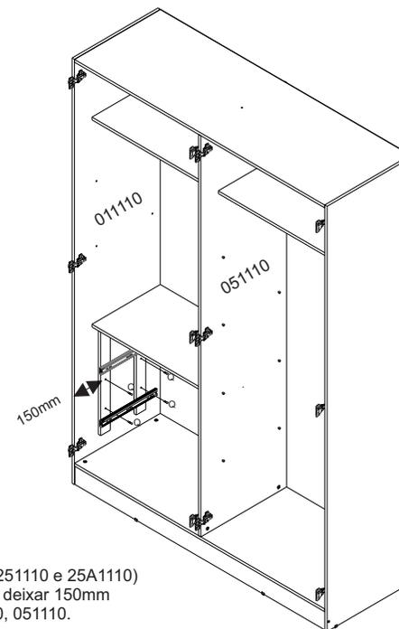
Fixar os calços de correção (251110 e 25A1110) com parafusos 3,5x35mm P e deixar 150mm de distância das peças 011110, 051110.
