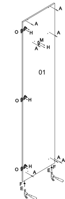
As dobradiças (O) podem ser montadas tanto na lateral esquerda (01) quanto na lateral direita (02) a depender do lado desejado para abrir a porta
