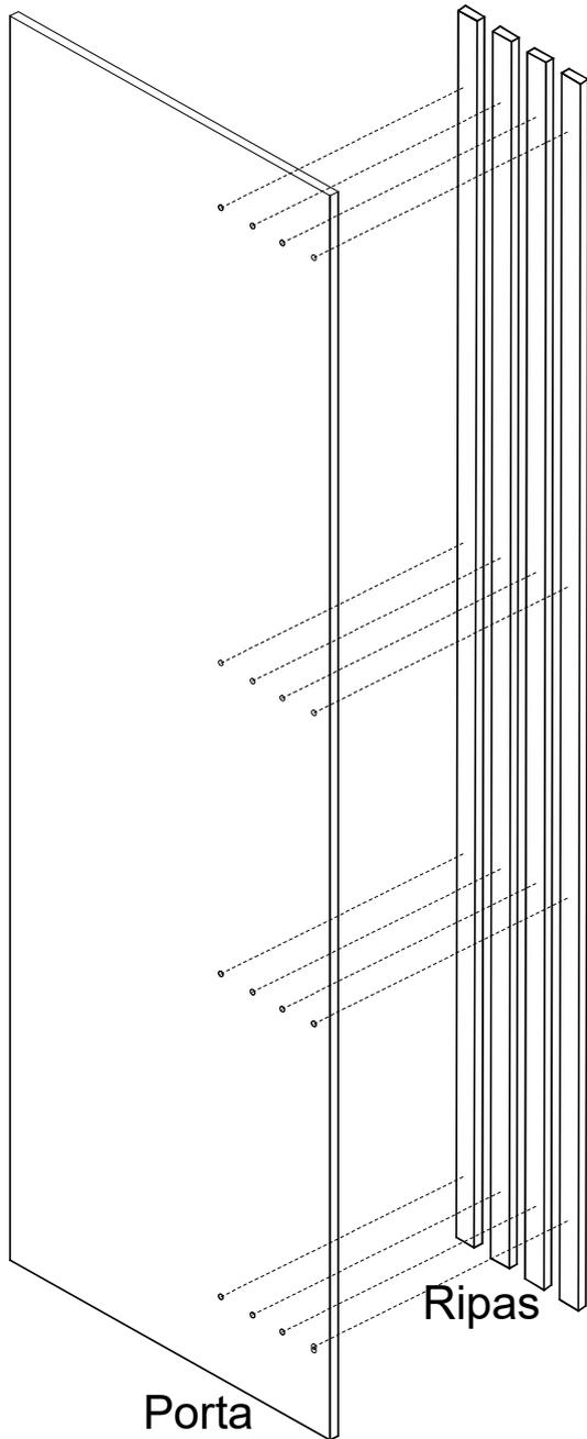
Com o parafuso 3,5x22 cab. Flang. fixe as ripas de dentro para fora das portas.
