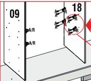
SR. MONTADOR, Instale os Distanciadores de corrediça (F) com parafuso (A) nas peças (09 e 18) conforme detalhe ao lado antes de fixar essas peças no conjunto do móvel.
