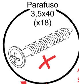
**ATENÇÃO:** esse parafuso só deve ser aplicado com o uso das Ripas. O uso sem ripas danificará o puxador atravessando por completo.
