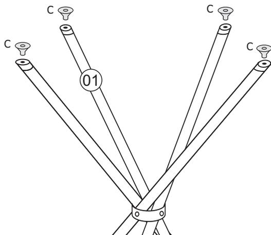
**06** - Após o procedimento do passo anterior, é a vez de rosquear as ventosas (C) nos orifícios existente nas ponteiros pata de cavalo (B).
