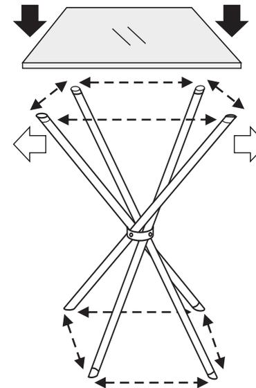
**05** - Segure com as mãos dois pés pela extremidade, e puxe no sentido para fora de maneira que todos os pés se abram até atingirem a posição de 45° grau. **OBS:** Essa abertura da estrutura da mesa deve ser feita em uma superfície plana, após a montagem não é necessário o reaperto os parafusos.
