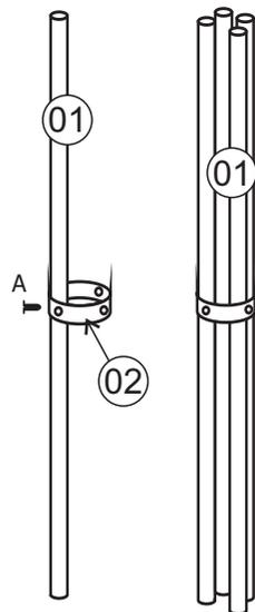
**04** - Encaixe uma estrutura pé (01) de cada vez pelo lado de dentro da argola de junção (02). Com os furos coincidindo coloque o parafuso (A) apertando sem arrotar, em seguida proceda da mesma forma com os demais estrutura pé (01).
