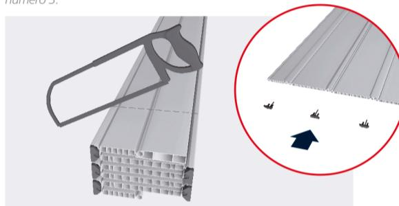
**2** Medir a altura (H) do vão livre e diminuir 4cm, traçando uma linha reta na parte inferior da articulação da Porta. Efetue o corte com mão firme usando um arco de serra para metais. Retire eventuais rebarbas resultantes do corte e recoloque as devidas tampas de união e parafusos na posição original. Em seguida corte os Montantes e o Gancho 2cm menor da altura (H).
