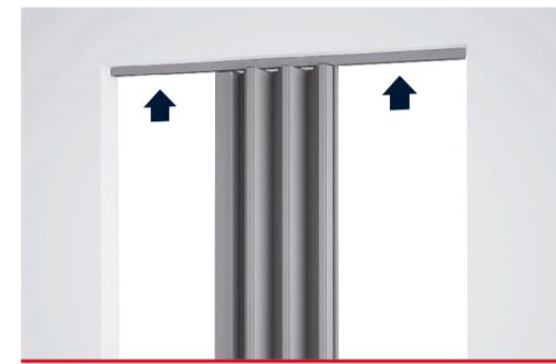
**5** Volte a Guia na posição e finalize a fixação com os parafusos 4,2 x 32mm.
