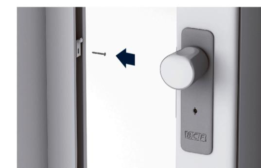
**4** Coloque o parafuso no furo oval sem apertá-lo totalmente, se necessário ajuste a posição da trava com a fechadura pelo furo oval. Após o ajuste, coloque o segundo parafuso no furo superior e aperte-o.
