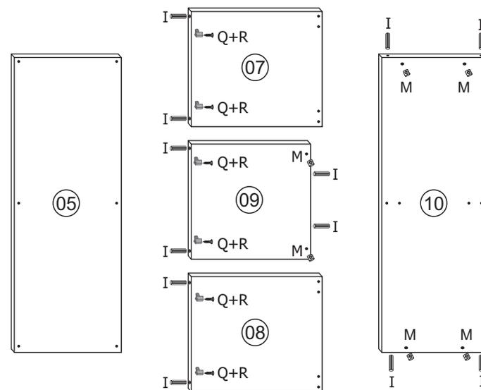
**06** - Batendo lentamente com um martelo, fixe-se as cavilhas (I) nas laterais (08) e (07) e na divisória (09).
