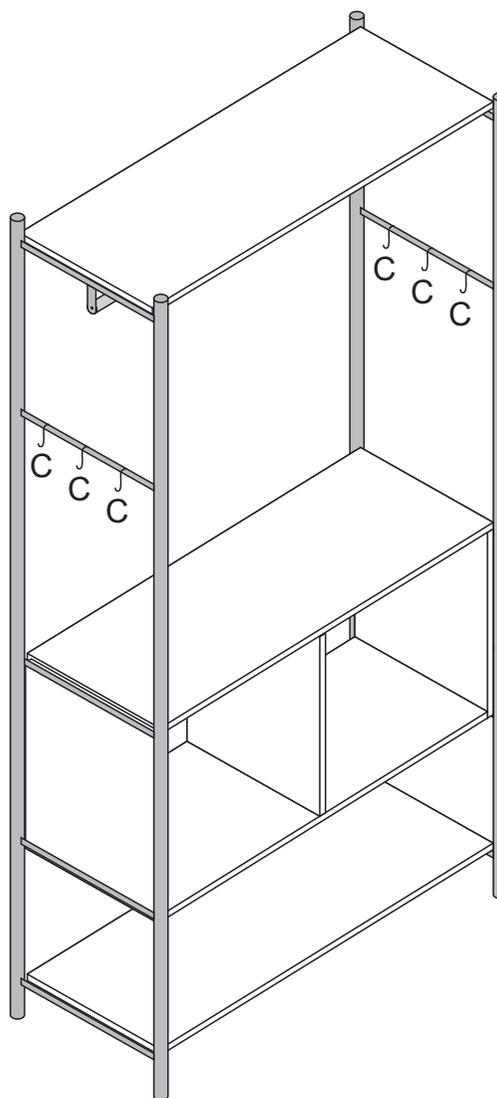
22 - Coloque os ganchos (C) nos orifícios existentes nas laterais do guarda roupa.
