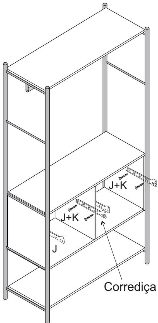
21 - Coloque na parte interna da caixa as corrediças das gaveta (J) parafusando com parafuso (K).
