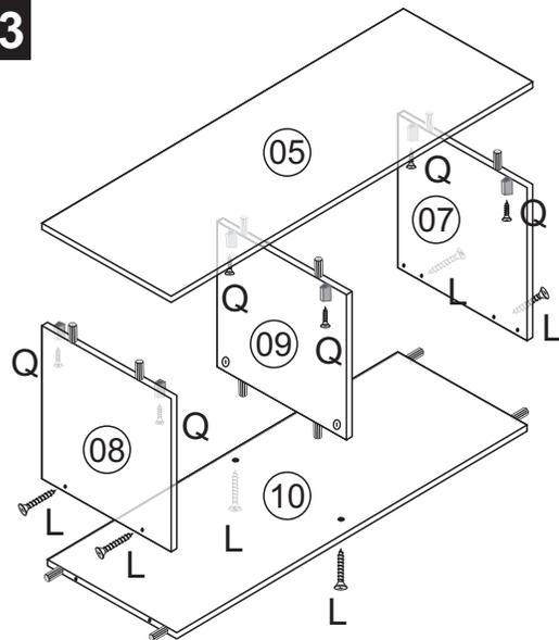
**09** - Parafuse a laterais (07) e (08) e a divisória (09) na peça (10) utilizando os parafusos (L).
