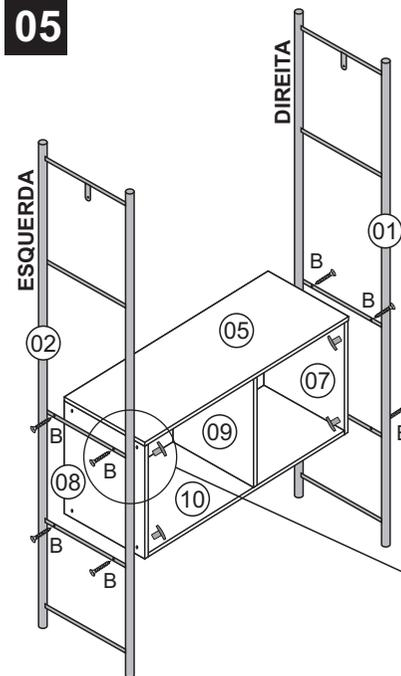
**12** - Parafuse a caixa nas peças (01) e (02), utilizando o C.J. parafuso (B). Não aperte totalmente.
