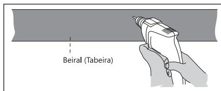
Inicie a fixação deixando o último suporte solto para que seja possível acoplar o próximo módulo. Se necessário, mantenha esta extremidade suspensa por um pedaço de barbante.
