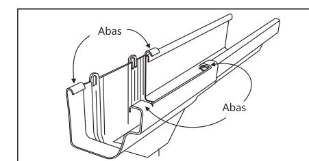
Note que este encaixe permite a movimentação da calha dentro do bocal de saída. Esta liberdade de movimento é necessária para absorver a dilatação e contração da calha, que naturalmente ocorre com a variação da temperatura ambiente.
