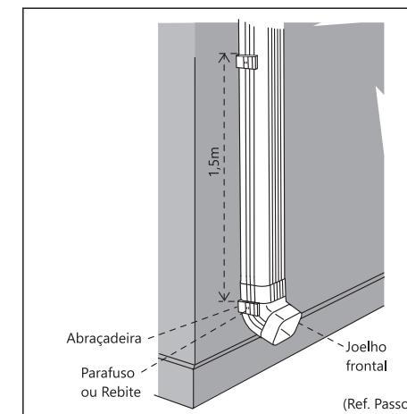
Caso o sistema de calha esteja montado distante da parede, encaixe um joelho frontal (CAL/JOF) na saída do bocal, observando o sentido do fluxo de água indicado por uma flecha na lateral da peça; em seguida corte um pedaço do condutor (CAL/CDT) que seja suficiente para alcançar a parede e o encaixe no joelho.
