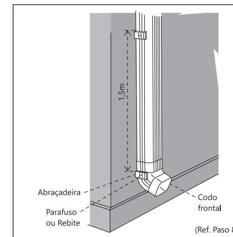
Si el sistema de canaleta está montado distante de la pared, encaje un codo frontal (CAL/JOF) en la salida de la boquilla, observando el sentido del flujo del agua indicado por una flecha en la lateral de la pieza; en seguida corte un pedazo del conductor (CAL/CDT) que sea suficiente para alcanzar la pared y el encaje del codo.
