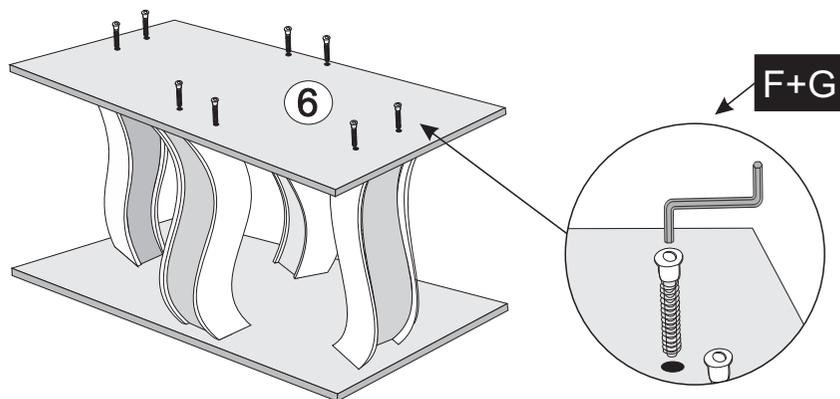
5º- CENTRALIZAR O TAMPO CONFORME MEDIDAS ABAIXO. FIXAR A BASE COM PARAFUSOS 04X25 FLANGEADO.
