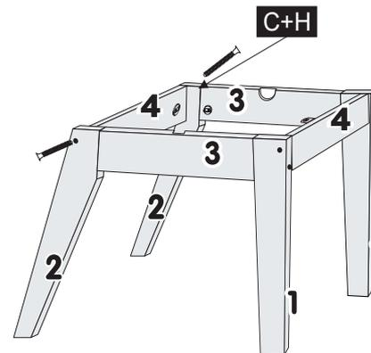
4º - TRAVAR OS PÉS TRASEIROS N.º2 E FRONTAL N.º1 COM AS TRAVAS LATERAIS N.º3 UTILIZANDO CHAPA JUNÇÃO 4 FUROS E PARAF. 3,5X20. EM SEGUIDA, FIXAR AS SAPATAS DESLIZADORAS NOS PÉS.
