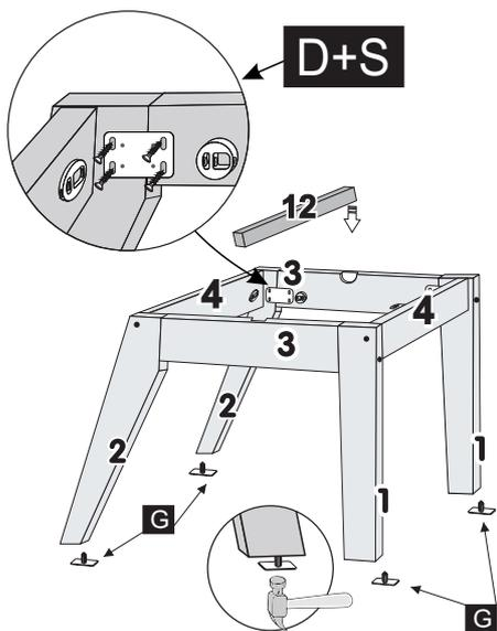
5º - FINALIZAR A MONTAGEM PARAFUSANDO O ASSENTO NO CHASSI DE PÉS UTILIZANDO CANTONEIRAS 2 e 4 FURROS + PARAFUSOS 3,5X10.
