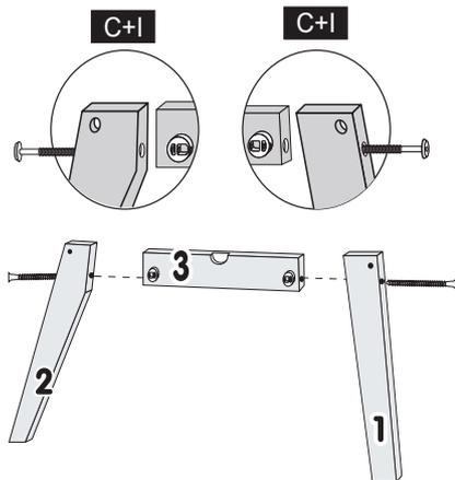
2º - UNIR O CONJUNTO LATERAL COM A TRAVA FRONTAL Nº4 UTILIZANDO ANEL FIXADOR + PARAFUSOS 1/4X70 CAB.13mm
