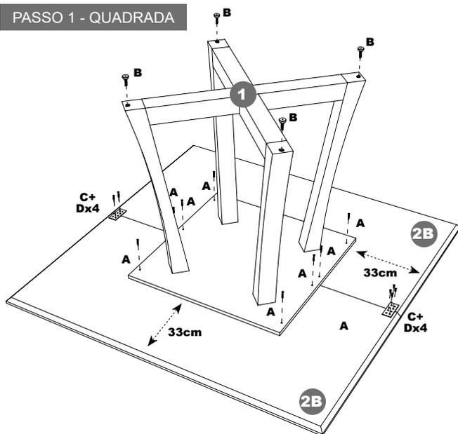
Alinhe os 2 tamos (2B) e fixe as chapas 35x80 (C) utilizando os parafusos 3,5x14 (D). Centralize a base da mesa (1) e fixe-a utilizando os parafusos 4,5x30 (A). Depois, coloque as sapatas reguláveis (B) nas buchas dos pés da mesa.
