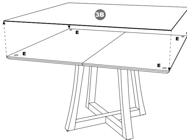
Cole o silicone adesivo (E) nos cantos do tampo da mesa, conforme indica o desenho e depois centralize o vidro (3B) sobre o tampo da mesa.
