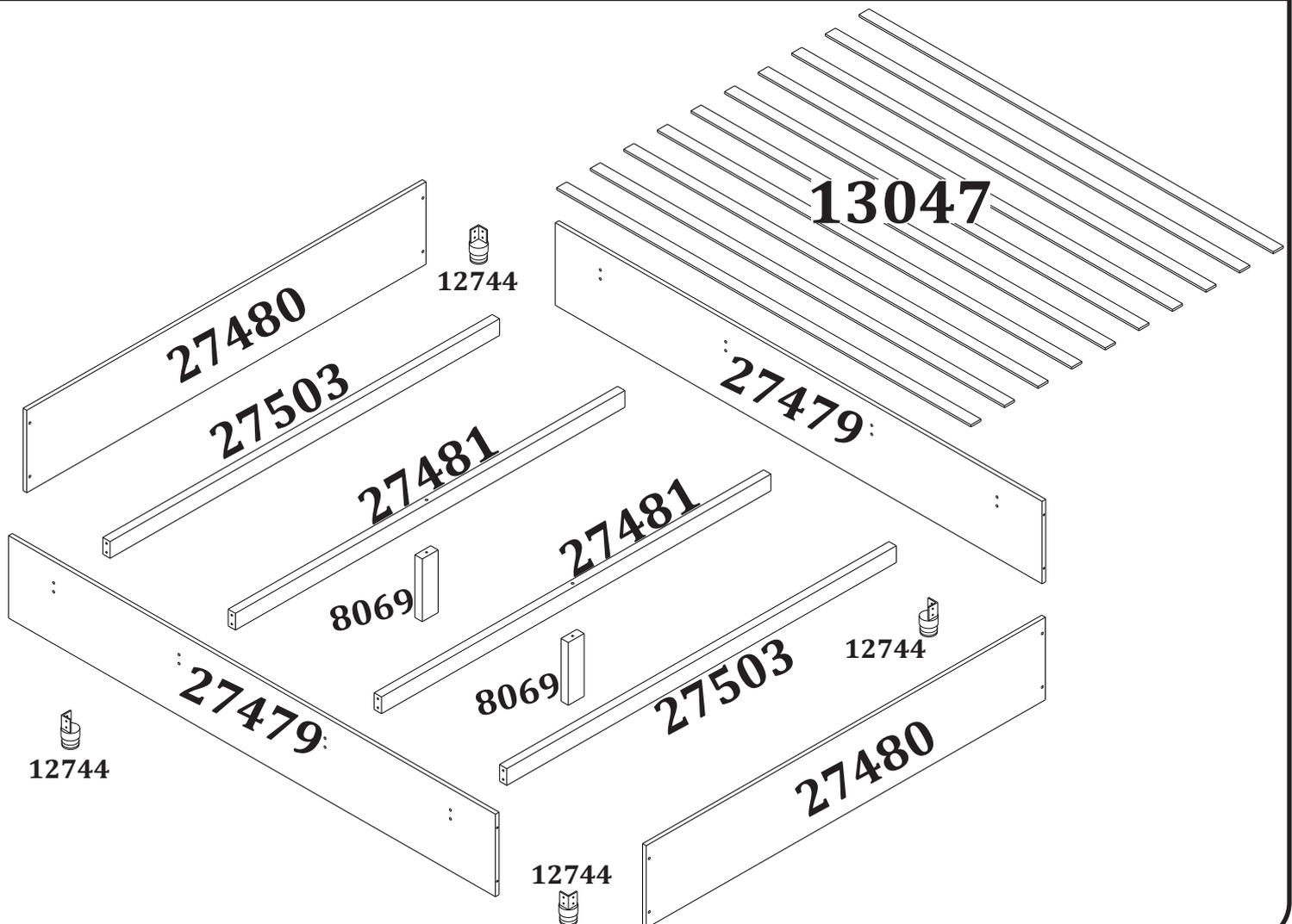
**1** Fixe as barras (27479) nos painéis (27480) utilizando os parafusos (2558). Em seguida, fixe os travessões (27503/27481) nas barras (27479) utilizando os parafusos (2558).
