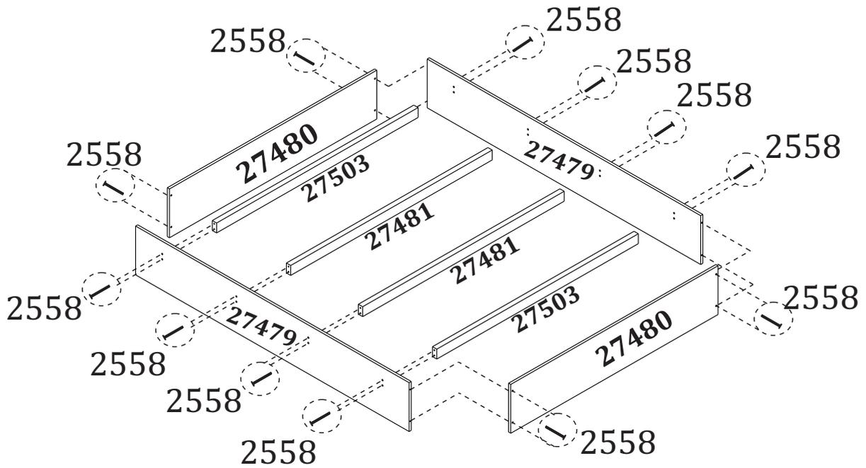
**2** Fixe os pés (12744) nos painéis (27480) e nas barras (27479) utilizando os parafusos (9292). Em seguida, fixe o quinto e sexto pé (8069) no travessão central (27481) utilizando os parafusos (2551).
