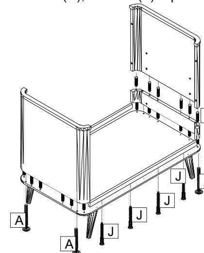
3º passo -Fixar grade - Colocar cavilha (L) em um das extremidades da grade, encaixar no conjunto inferior da cabeceira (02) fixar a grade com parafuso 1/4 x60 (A), na peseira (03) e no conjunto da cabeceira (01 e 02)
