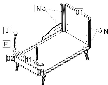
**4º passo -**Fixação da mini grade com parafuso 3,5x16 cabeça chata (B)
