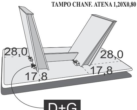
2º-CONTINUAR A MONTAGEM UTILIZANDO PARAFUSOS 7X40 CAB 10 mm NA JUNÇÃO DAS PEÇAS Nº 3 E Nº 4. E FINALIZAR ESSE PASSO COM AS SAPATAS REGULÁVEIS + BUCHA AMERICANA.
