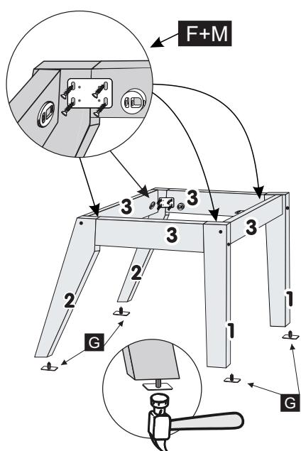
6º - FINALIZAR A MONTAGEM PARAFUSANDO O ASSENTO NO CHASSI DE PÉS UTILIZANDO CANTONEIRAS 04 FUROS +PARAFUSOS 3,5X10.
