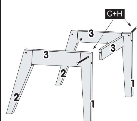
3º - FINALIZAR COM A TRAVA TRASEIRA N°3 UTILIZANDO ANEL FIXADOR + PARAFUSOS 1/4X70 CAB.13mm
