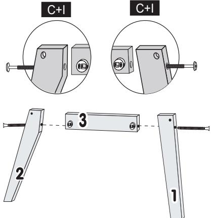
2º - UNIR O CONJUNTO LATERAL COM A TRAVA FRONTAL N°3 UTILIZANDO ANEL FIXADOR + PARAFUSOS 1/4X70 CAB.13mm
