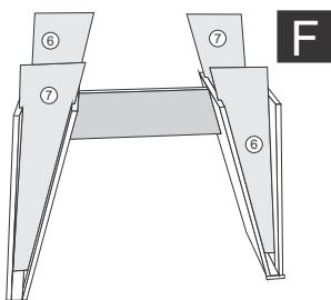
5º- CENTRALIZAR A BASE NO TAMPO UTILIZANDO AS MEDIDAS ABAIXO. TAMPO RAVENA DE 1,60X0,80. FINALIZAR COM CANTONEIRAS 4 FUROS + PARAFUSOS 3,5X14
