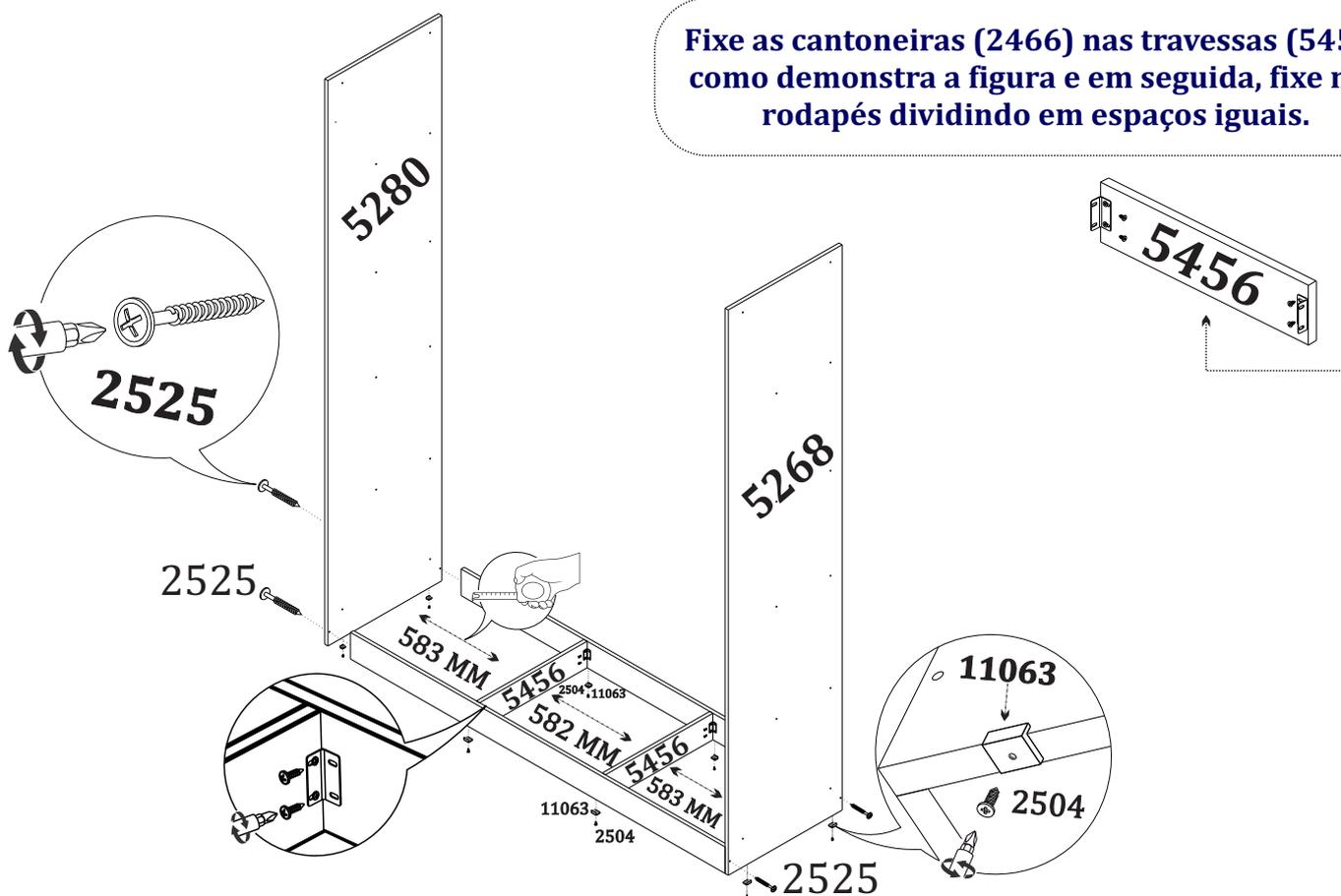
**2** Fixe a base (28691) nas laterais utilizando os parafusos (2525) e em seguida fixe sobre os rodapés com os parafusos (2505).
