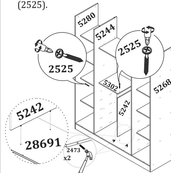
**6** Encaixe o tampo (28692) sobre as cavilhas fixadas nas divisões e em seguida, fixe nas laterais utilizando os parafusos (2525).
