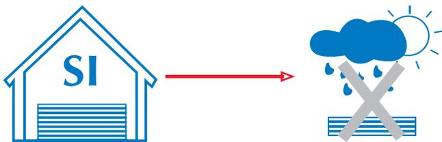
Las láminas se deben almacenar con la cara que tiene la protección UV hacia el exterior, la cual se distingue por las indicaciones gráficas de la película plástica protectora.
