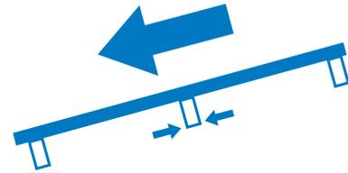
Las láminas deben quedar con la cara que tiene la protección UV hacia el exterior.
