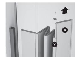
2. Desparafuse a Tampa da União (Y) e retire apenas o Perfil Lâmina (A). Reserve esse Perfil junto com a tampa e o parafuso. Estes serão utilizados mais adiante.
