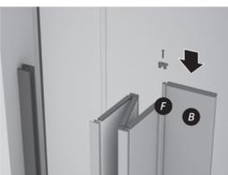
4. Com o Perfil Lâmina Batedor (B) em mãos, insira o mesmo no Perfil União (F) no lugar onde estava o conjunto montado. Parafuse a Tampa no Perfil União (F).
