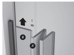
3. Desparafuse a Tampa da União (X) e retire o Perfil Lâmina Batedor (B). Mantenha o Perfil Lâmina Batedor (B) em mãos para o passo seguinte.
