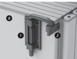
8. Posicione o Trinco/Puxador (1) com o Contra Trinco (2) na Lâmina Batedor (B). Marque com um lápis os 4 furos do Trinco/Puxador (1). Com a ajuda de uma pequena chave de fenda phillips, pontee levemente para facilitar a entrada do parafuso no Perfil Lâmina Batedor (B).
