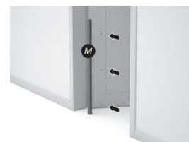
1. Posicione o Perfil Montante (M) no prumo e no centro do vão; faça 3 furos equidistantes (use broca para metais de 4mm). Parafuse o Perfil Montante (M) no batente do vão. Se o vão for em alvenaria ou gesso, utilize as buchas plásticas fornecidas na embalagem.
