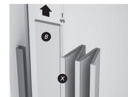
3. Desparafuse a Tampa da União (X) e retire o Perfil Lâmina Batedor (B). Mantenha o Perfil Lâmina Batedor (B) em mãos para o passo seguinte.
