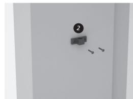
11. Parafuse o Contra Trinco (2) no Batente. Se o vão for em alvenaria ou gesso, utilize as buchas plásticas fornecidas na embalagem.
