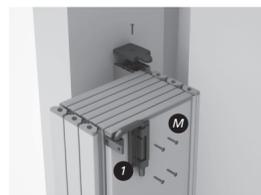
11. Parafuse, delicadamente, o Trinco/Puxador (1) com os parafusos 2,9x9,5mm e Tampa de Acabamento do Perfil Montante (M) com os parafusos 4,2x19mm. Utilize uma pressão mínima para não espanar a superfície dos perfis.
