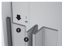
5. Insira o Perfil Lâmina (E) do Kit Extensor no Perfil União (X) e parafuse a Tampa no mesmo.
