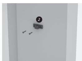
13. Parafuse o Contra Trinco (2) no Batente. Se o vão for em alvenaria ou gesso, utilize as buchas plásticas fornecidas na embalagem.
