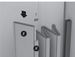
4. Insira o Perfil Lâmina Adicional (E) do Kit Extensor na União (X). Parafuse a Tampa na União (X).
