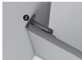
10. Feche a porta e posicione o Contra Trinco (2) no vão oposto seguindo o detalhe em evidência.
