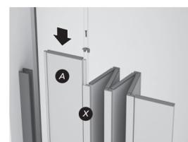
5. Insira agora o Perfil Lâmina (A), previamente reservado (fig.3), no Perfil União (X) e reparafuse a tampa.
