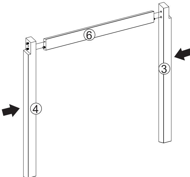
**6** Posicione os pés e faça a fixação conforme desenho.
