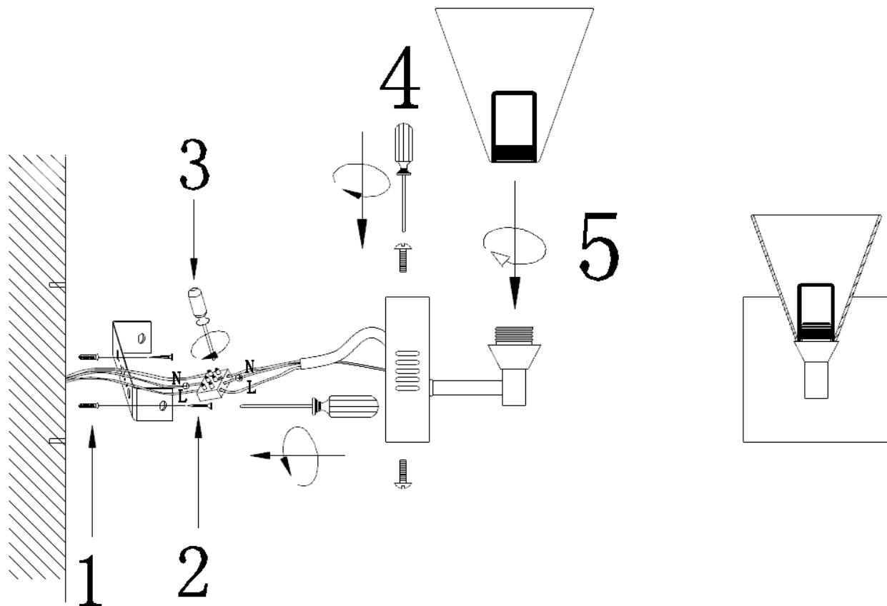
1. e 2. Instale as buchas no teto e instale a travessa com os parafusos no teto.
