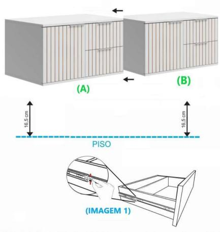
Retirada da Gaveta: Primeiro abrir totalmente a gaveta. Ao mesmo tempo, do lado esquerdo, pressione o dispositivo para cima e do lado direito, pressione o dispositivo para baixo. Em seguida, puxe a gaveta.
