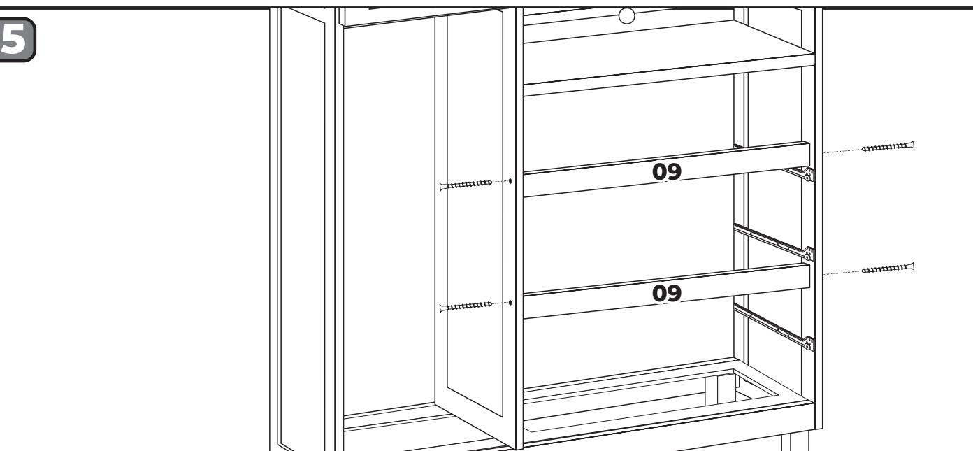
Fixar os batentes de gavetas 9 com parafuso 4,0x45 conforme figura acima.
