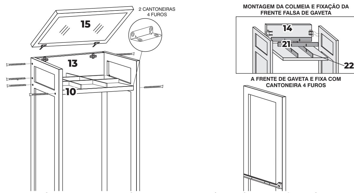
Fixar coméia 10 com parafuso 4,0x45 e parafusar as 2 cantoneiras 4 furos nas laterais conforme figura acima
