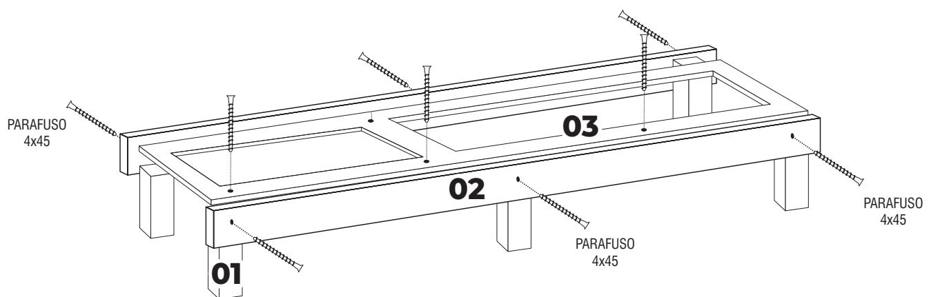
Parafusar rodapés nº 02 nos pés nº 1 utilizando parafuso 4,0x45 e parafusar os pés 1 na base 3 com parafuso 4,0x45 como mostrado na figura acima.
