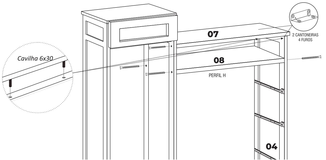
Fixar tampo 7 com parafuso 4,0x45 na lateral 6 e com 2 cantoneiras na lateral 4 e depois parafusar a prateleira 8 com parafuso 4,0x45 conforme figura acima.
