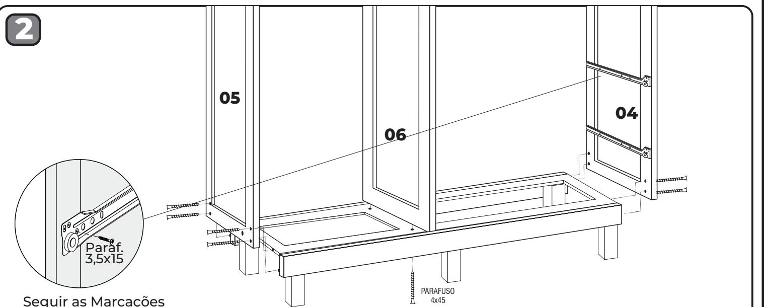
Parafusar as laterais 4, 5 e Divisão 6 com parafuso 4,0x45 como mostrado na figura acima.
