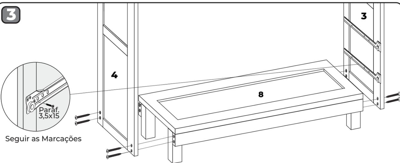
Fixar laterais 03 e 04 na base 08 com parafusos 3,5x45 conforme figura acima.
