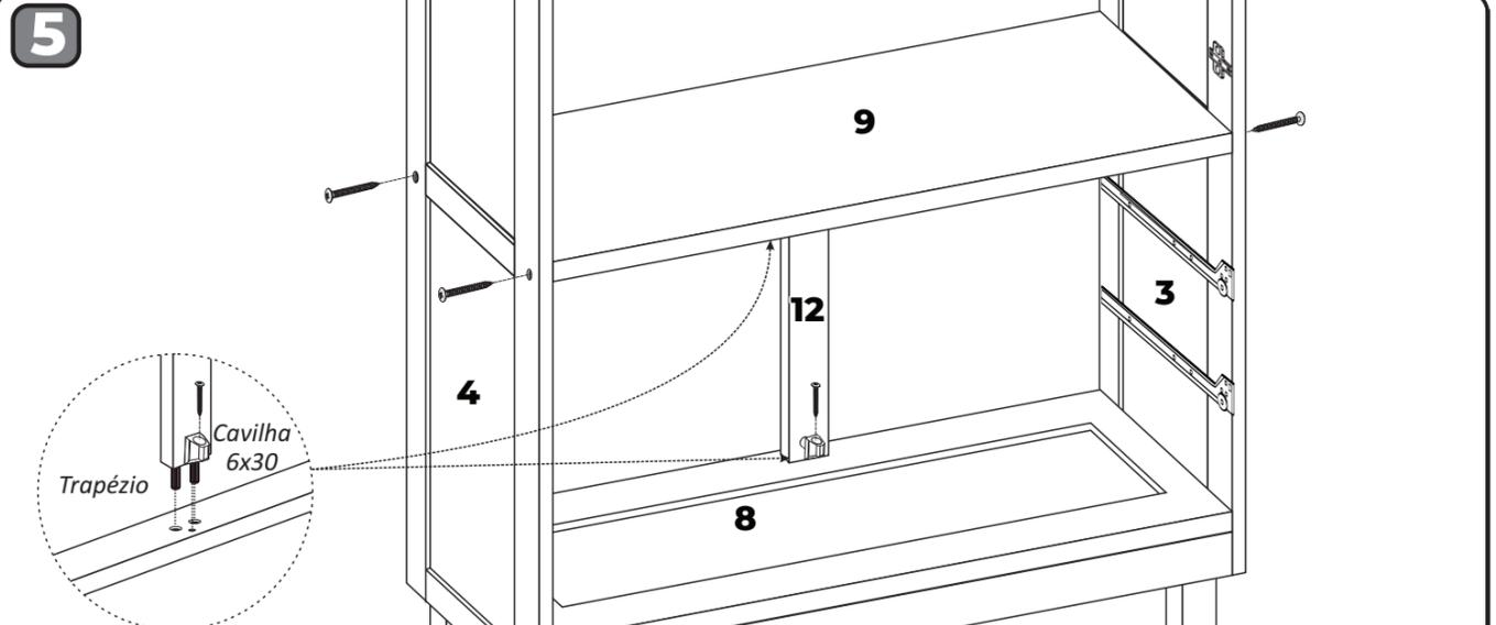
Fixar prateleira 09 com parafuso 3,5x45 e depois parafusar o batente menor 12 cavilha e dispositivo trapézio conforme figura acima.
