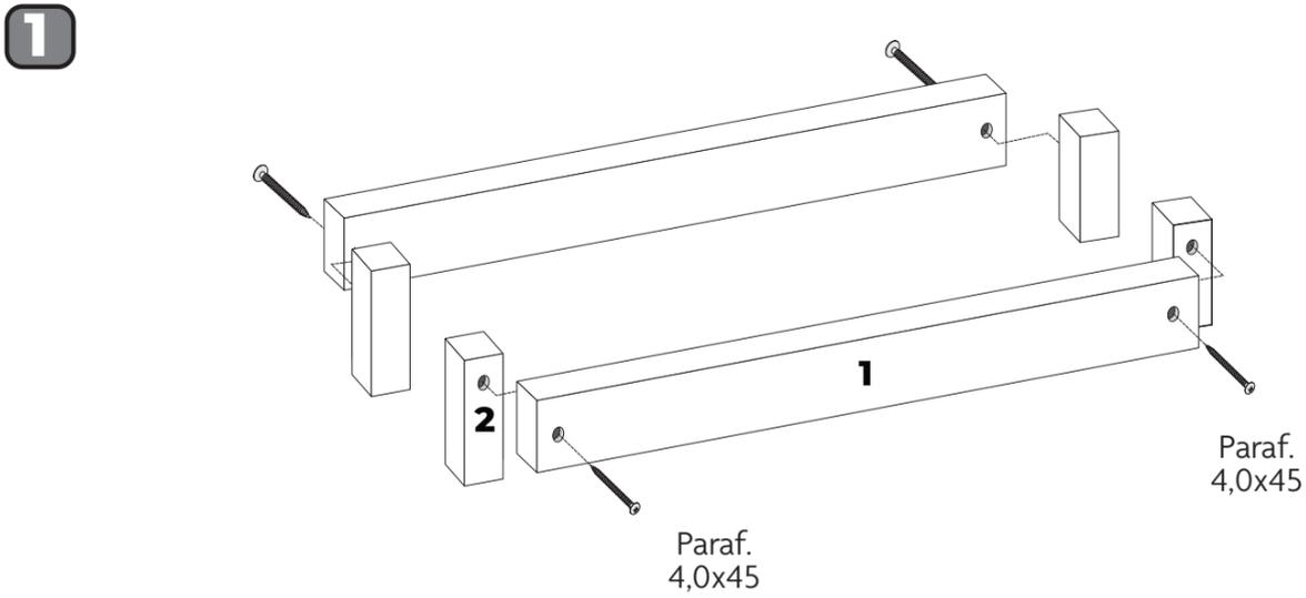
Parafusar rodapés nº 01 nos pés nº 2 de fora para dentro utilizando parafuso 4,0x45 como mostrado na figura acima.
