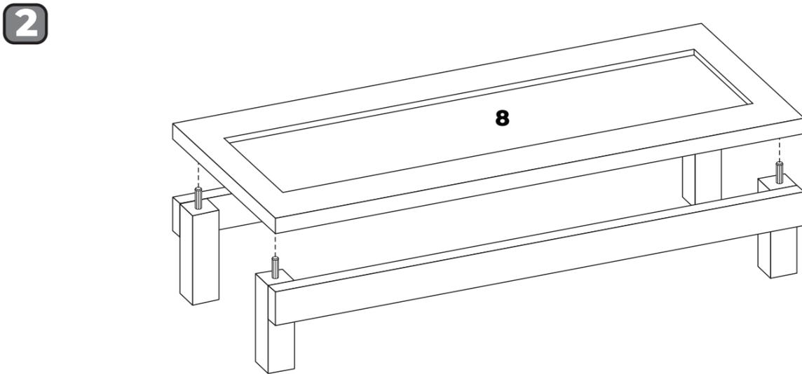
Fixar base/tampo 8 sobre os pés já montados utilizando cavilhas conforme figura acima.
