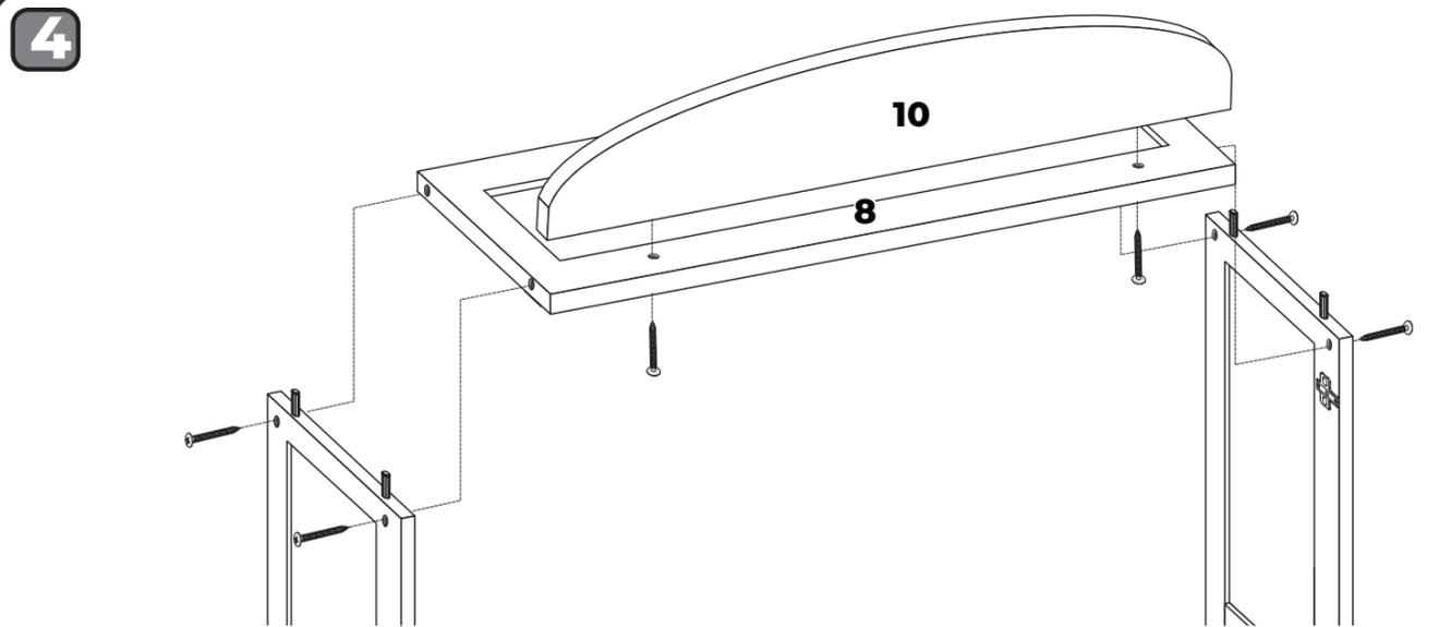
Fixar tampo 08 nas laterais 03 e 04 parafusos 3,5x45 e 2 cavilhas em cada lado e depois parafusar o chapéu 10 com parafuso 3,5x45 conforme figura acima.
