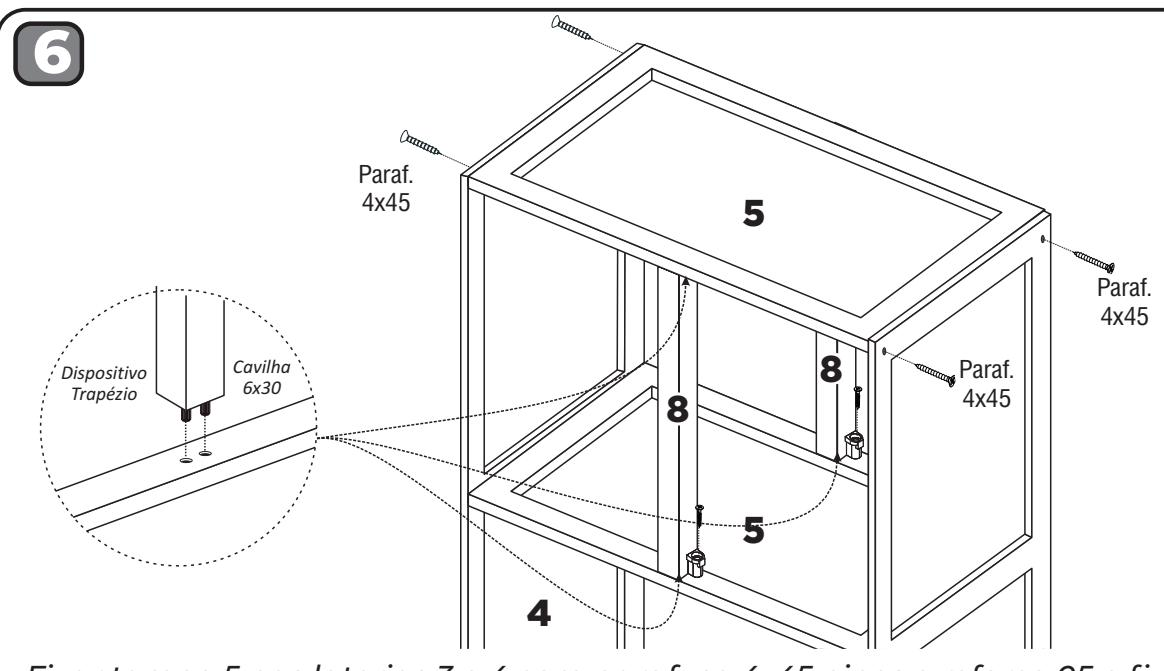
Fixar tampo 5 nas laterais 3 e 4 com parafuso 4x45 pinos e reforço 05 e fixar bantentes pequenos com cavilha e dispositivo trapézio conforme figura acima.
