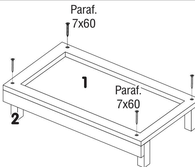
Parafusar rodapés nº 01 nos pés nº 2 de dentro pra fora utilizando parafuso 6,0x60 e parafusar as laterais como mostrado na figura acima.
