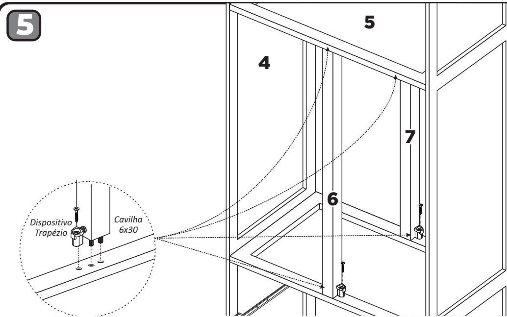
Fixar batentes 6 e 7 com cavilha 6x30 e dispositivo trapézio conforme figura acima.
