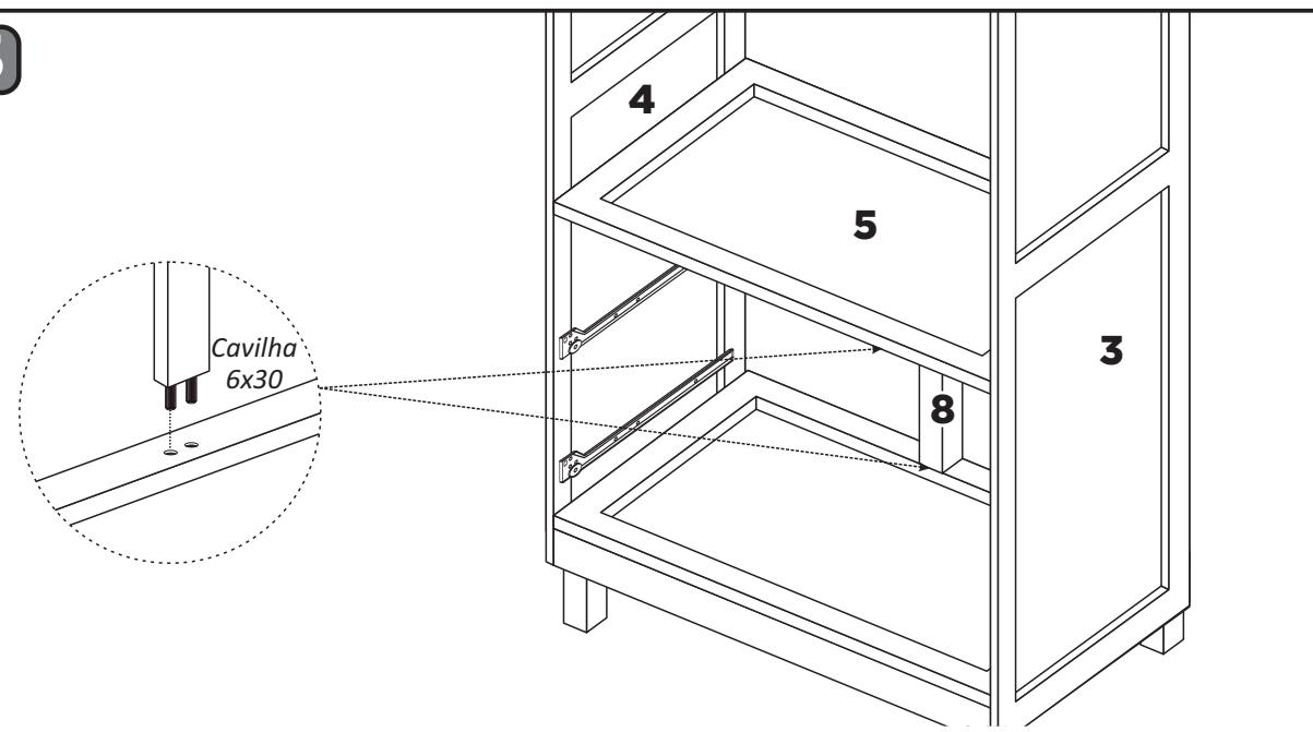
Fixar batente menor 8 com cavilha 6x30 conforme figura acima
