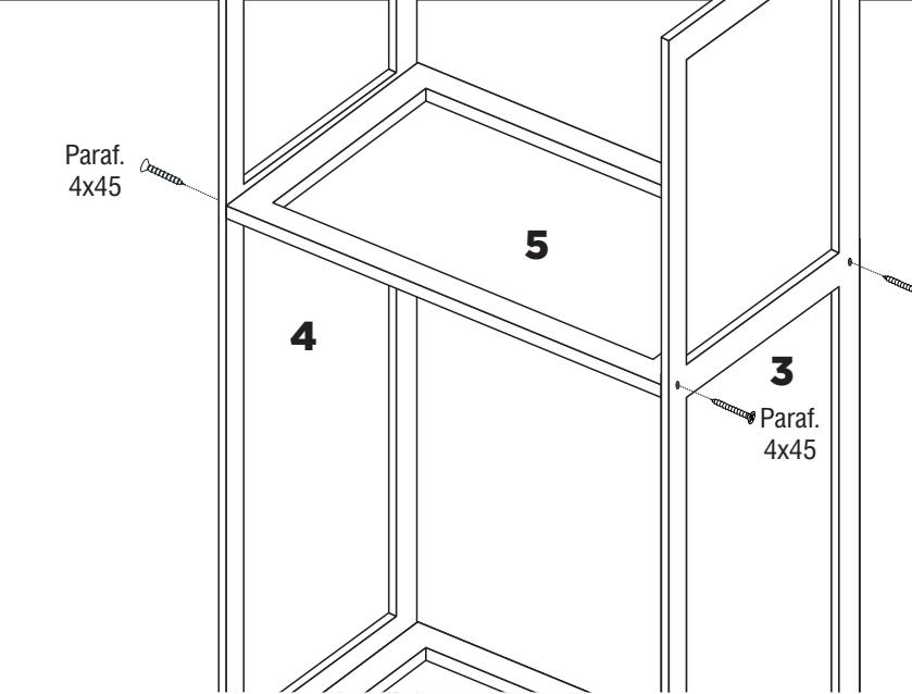
Fixar tampo 5 nas laterais 3 e 4 com parafusos 4x45 conforme figura acima.
