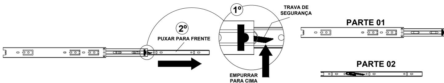
8º - Parafuse a **parte 01 das corredeiras** na lateral direita, na lateral esquerda, na divisão e nos batentes das corredeiras, seguindo as marcações, utilizando o **parafusos 3,5x14 Ch. Ph.**
