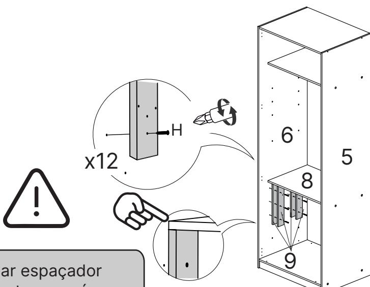
Facear espaçador com o topo, após parafusar.
