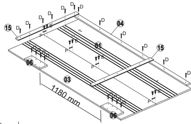
**Atenção:** Aplicar cola nas faces de contato entre fixadores 15 e painéis 01, 02 e 03.
